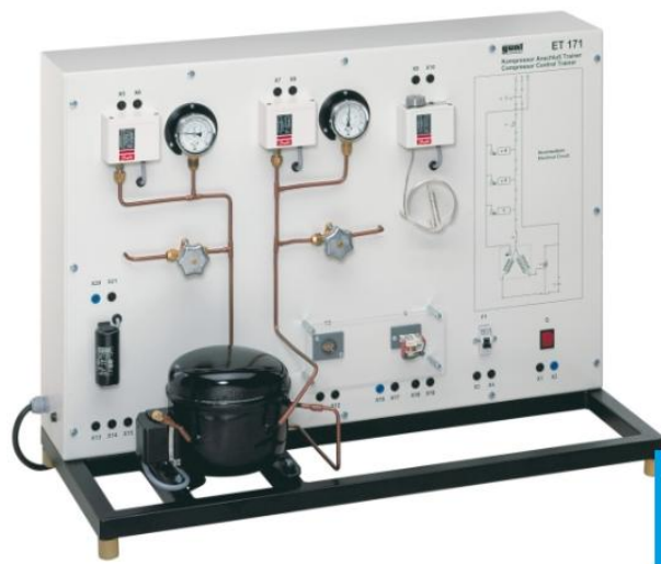
ET 171 Collegamento elettrico dei compressori frigoriferi
