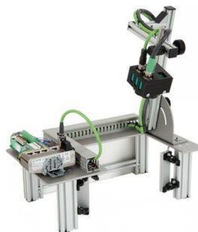
IMS 18 Ispezione della telecamera del sottosistema
